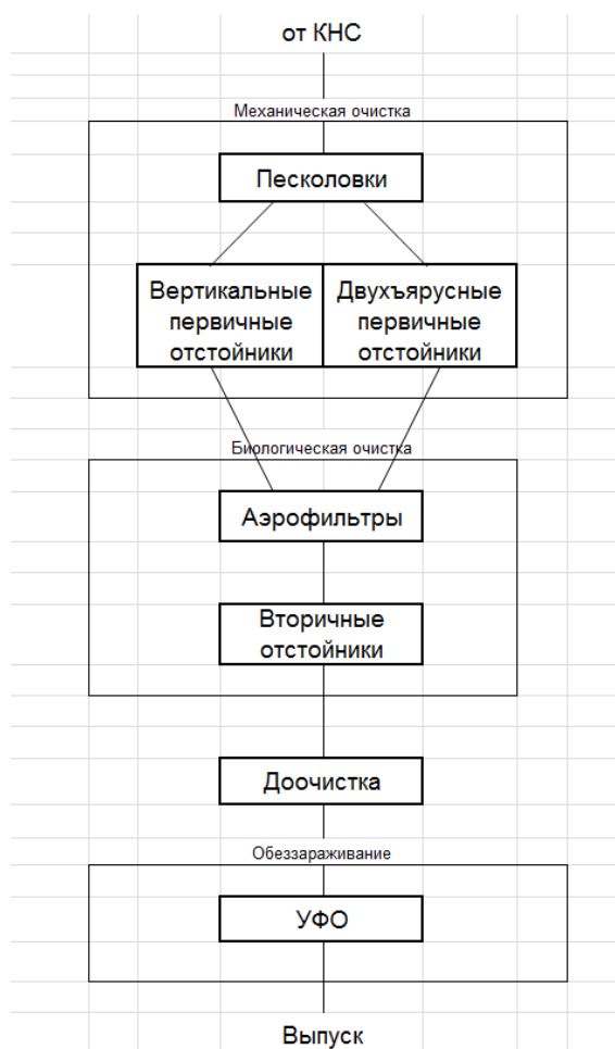
Рисунок 1.1 - Технологическая схема процесса очистки сточных вод
